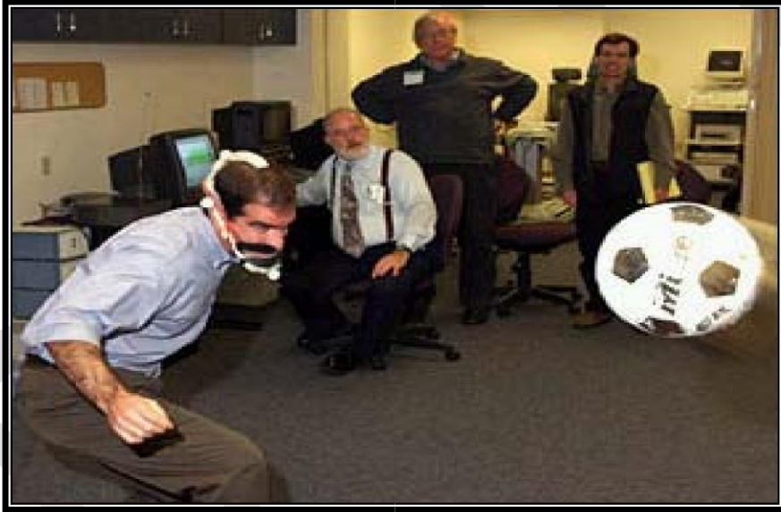
شكل 26. يوضح أحد الأجهزة الموضوعة على الرأس لقياس قوة الضربة .
